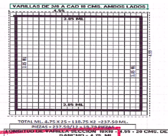
CERRAMIENTO DE Y DALA DE BASE ARMEX CON CONCRETO FC 150
